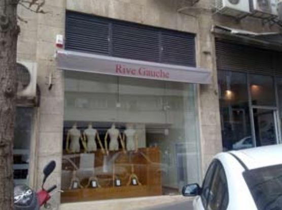
הסתרת מנוע מזגן על ידי תריס רפפה מברזל
